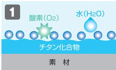
素材に密着したチタン化合物に、大気中の酸素、水分等が接触。これにより、チタン化合物の表面に活性酸素等が発生。
