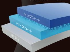
新車の輝き、艶を維持、そして美しさを守る。汚れが滑りやすく、水切れもよい「滑落性」と「流水性」で水洗いだけのラクなお手入れを実現。更にガラス2層皮膜でボディを強靱に保護し「耐久性」を実現。これがダイハツ純正「デラックスコーティング プロ」です。
